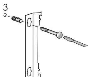
Просверлите отверстие диаметром 6 мм, вбейте дюбель и при помощи самореза закрепите кронштейн. Для деревянной стены отверстие делать не нужно, воспользуйтесь саморезом без дюбеля.
